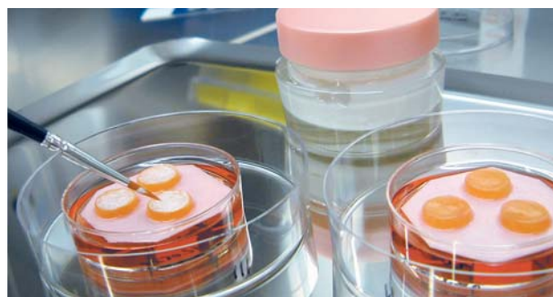
Les méthodes alternatives aux tests sur les animaux : mis au point par Henkel, ce modèle de peau permet d'évaluer systématiquement les effets des substances sur les tissus de la peau.
