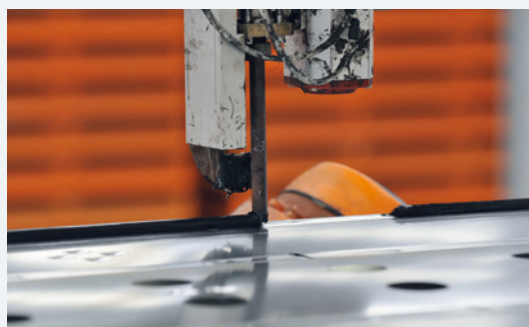
Terostat MS viene automaticamente estruso sui telai d'acciaio ai quali vengono fissati gli specchi.
