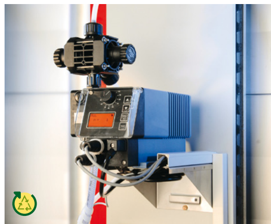
Il sistema Lineguard Supervisor di Henkel, per il controllo e il monitoraggio continuo dei processi di pre-trattamento dei metalli, permette di stabilire con precisione la quantità di sostanze chimiche necessarie. Oltre a evitare un dosaggio eccessivo, il sistema uniforma la qualità dei rivestimenti.
