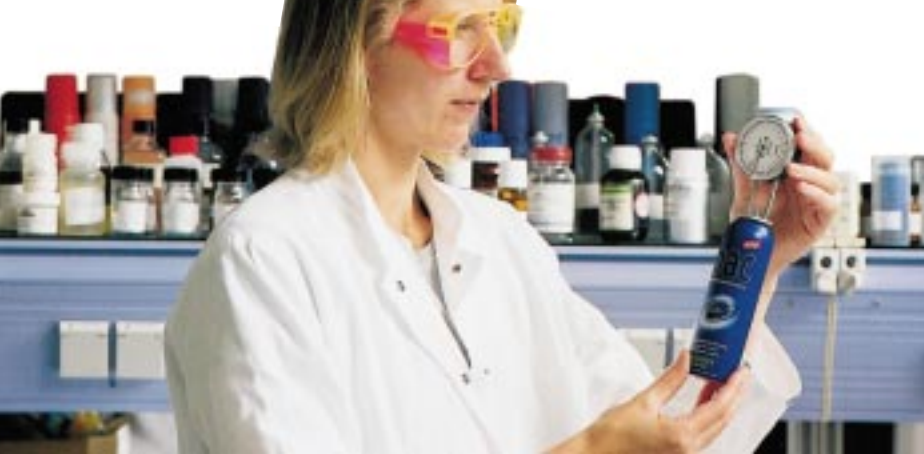
Produktentwicklung von Sprays bei Schwarzkopf in Hamburg: Ventil-Clinchwertbestimmung einer Aerosoldose, 2001.
